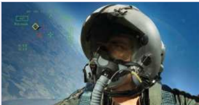
Pilote portant un casque à affichage JHMCS II d'Elbit. Source : elbitsystems.com (note 10)
